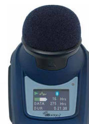
Display toont resterende batterijduur en geheugencapaciteit
