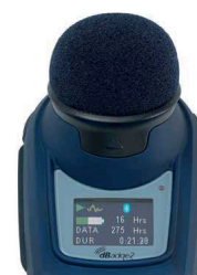
Display toont resterende batterijduur en geheugencapaciteit
