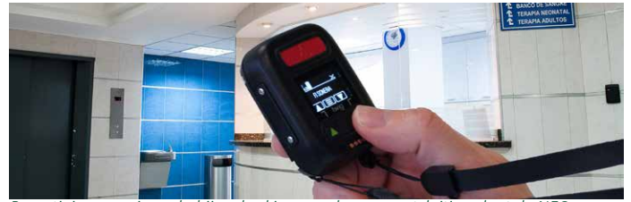
Bevestiging aan ripcord - bij verbreking van de magneetsluiting slaat de NEO automatisch alarm.
